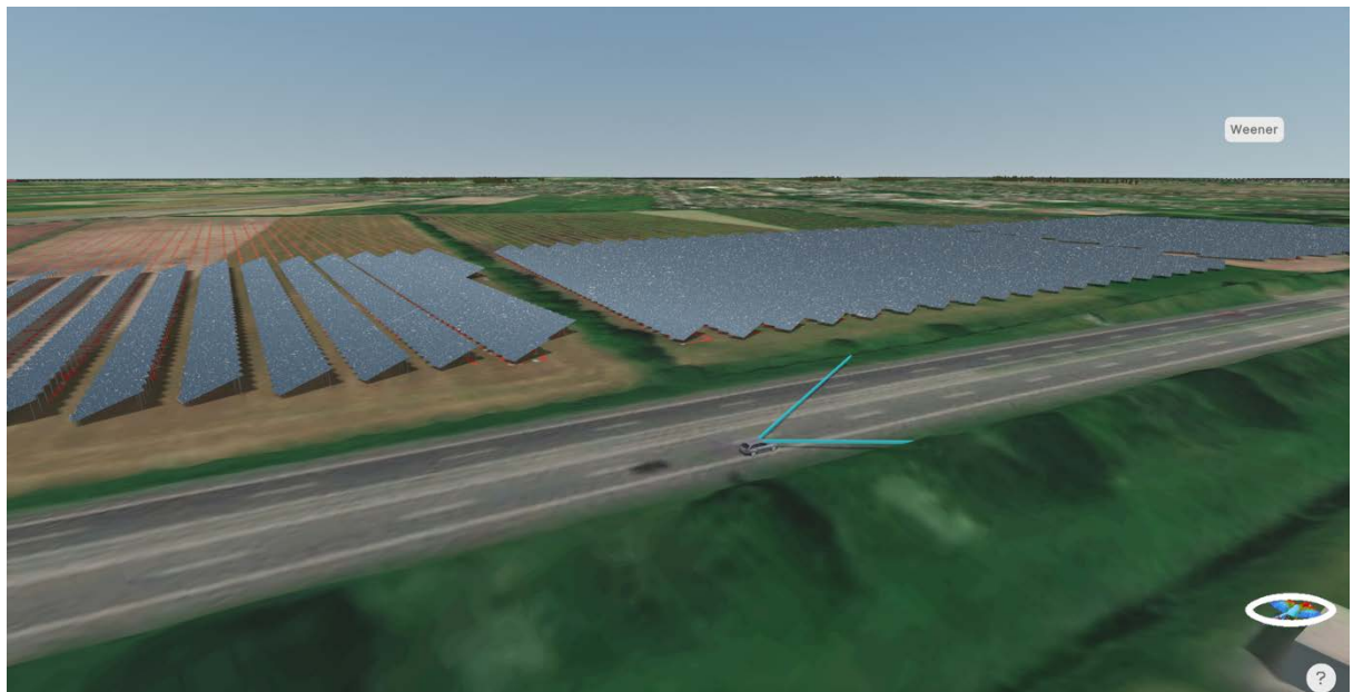
ABBILDUNG 24: ANSICHT DES IP3 MIT EINEM PKW IN FAHRTRICHTUNG NORD UND DEM ZENTRALEN GESICHTSFELD DES FAHRERS (BLAUE BALKEN)
