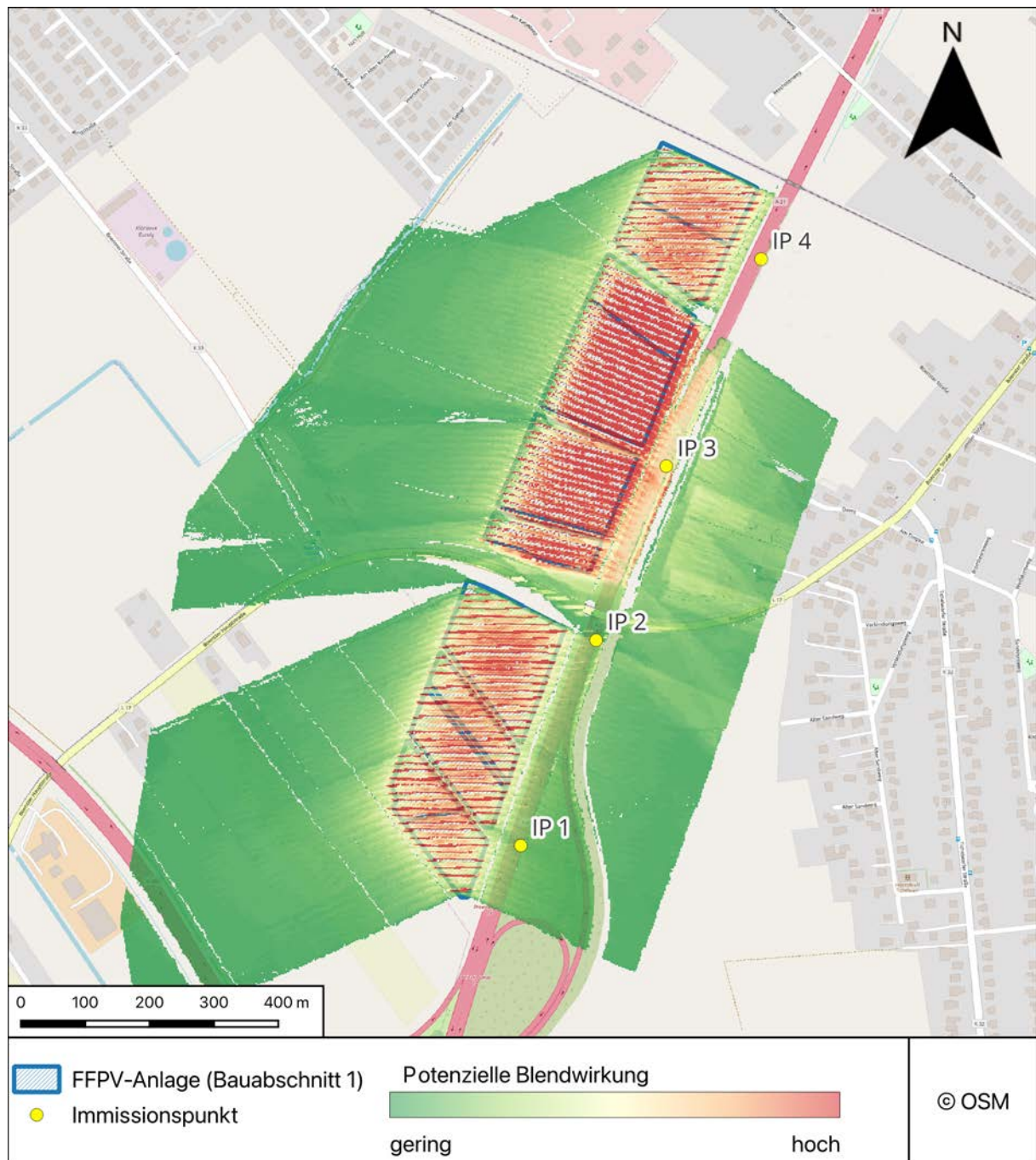
KARTE 4: ÜBERSICHT ÜBER DEN PV-PARK MIT POTENZIELLER BLENDWIRKUNG AUF BODENHÖHE AM 21. TAG DER MONATE MÄRZ, JUNI, SEPTEMBER UND DEZEMBER (KUMULIERT DARGESTELLT) MIT DER SICH DARAUS ERGEBENDEN AUSWAHL DER IMMISSIONSPUNKTE
