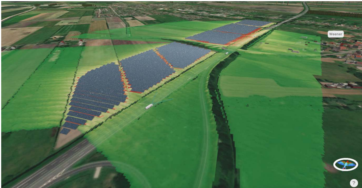
ABBILDUNG 6: 3D-VISUALISIERUNG MIT DER ÜBERSICHT ÜBER DEN UNTERSUCHUNGSRAUM MIT LKW AN DEN IP UND DER KUMULIERT DARGESTELLTEN POTENZIELLEN BLENDWIRKUNG (21. MÄRZ, JUNI, SEPTEMBER UND DEZEMBER 2023; GRÜN = GERINGES BLENDPOTENZIAL, GELB = MITTLERES BLENDPOTENZIAL, ROT = HOHES BLENDPOTENZIAL)
