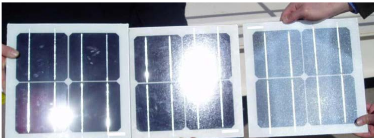
ABBILDUNG 5: BEISPIELE FÜR REFLEXIONEN UND STREUUNG DES LICHTS AUF VERSCHIEDENEN PV-MODULEN MIT UNTERSCHIEDLICHER OBEFLÄCHENSTRUKTUR. VON LINKS NACH RECHTS: GLATTES GLAS, LEICHT TEXTURIERTES GLAS MIT ANTIREFLEXIONS BESCHICHTUNG UND TIEF STRUKTURIERTES GLAS (QUELLE: YELLOWHAIR UND HO: ASSESSMENT OF PHOTOVOLTAIC SURFACE TEXTURING ON TRANSMITTANCE EFFECTS AND GLINT/GLARE IMPACTS, 2015).
