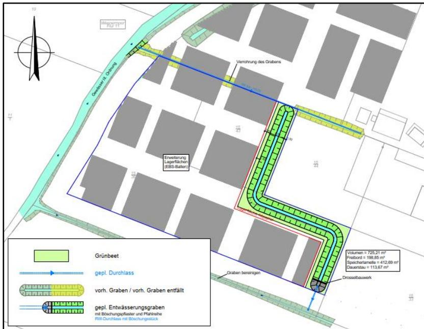
Abbildung 5: Lageplan Variante 1, Entwässerung über Gräben
