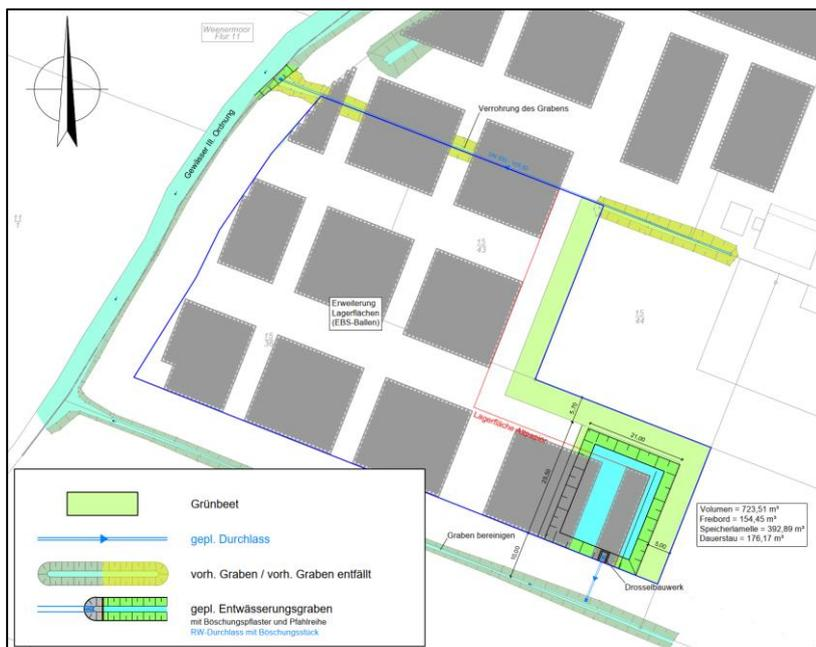
Abbildung 6: Lageplan Variante 2, Entwässerung über Regenrückhaltebecken
